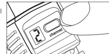
Los canales del receptor y transmisor deben coincidir.
