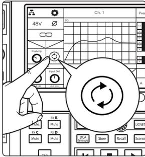
Una vez que ha ajustado los niveles de los previos, active Gain Compensation desde la pantalla LCD. Esto activará la compensación de ganancia (Gain Compensation) para esa entrada y permitirá a los otros mezcladores de la red tomar como fuente esa transmisión.
