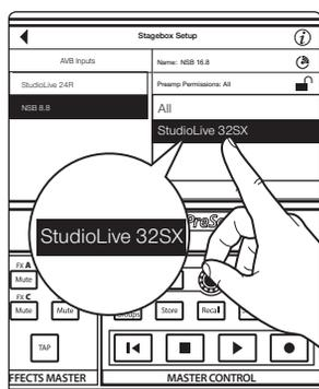
Los previos de las NSB-series stage boxes pueden controlarse desde cualquier mezclador StudioLive Series III en la red. Cuando tenga una stage box alimentando a más de un mezclador, se recomienda que de sólo permiso a un mezclador para ajustar los niveles de los previos de la NSB. En nuestro ejemplo, estaremos dando permiso al StudioLive 32SX en el Front-of-House.
