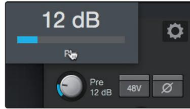
Una vez que ha ajustado los niveles de los previos, active Gain Compensation. Esto activará la compensación de ganancia (Gain Compensation) para esa entrada y permitirá a los otros mezcladores de la red tomar como fuente esa transmisión.
