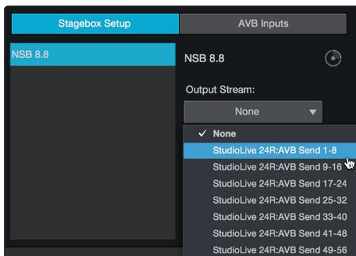
*Nota:* Debe asignar una transmisión de salida desde su mezclador a su cajetín de escenario NSB-series para configurar correctamente una sincronización de reloj en la red. Si no asigna una transmisión de salida desde su mezclador, su cajetín de escenario configurado en red no estará correctamente sincronizado y escuchará artefactos y ruidos en el audio. Para más información sobre sincronización de reloj sobre AVB, por favor consulte la *Guía de interconexión AVB de StudioLive Series III*.
