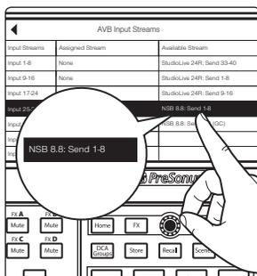
Cuando use una consola StudioLive Series III como controlador maestro de los previos para su NSB-series stage box, seleccione las transmisiones sin compensación de ganancia para sus entradas.
