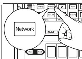
Después de encaminar las entradas NSB a la consola de su mezclador, seleccione Network para la fuente en los canales correspondientes.
