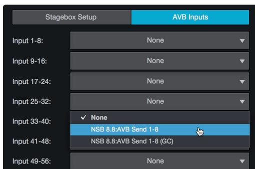
**Nota:** Los cajetines de escenario NSB tienen dos conjuntos de transmisiones: uno con compensación de ganancia y otro sin. En nuestro ejemplo, la StudioLive 24R tiene control total sobre los previos de la NSB stage box y es el único mezclador conectado a sus transmisiones, por ello, en este ejemplo no se requiere compensación de ganancia. Por favor, repase la Sección 3 para más información sobre compensación de ganancia (Gain Compensation) y cuando es una ventaja o incluso un requisito.
